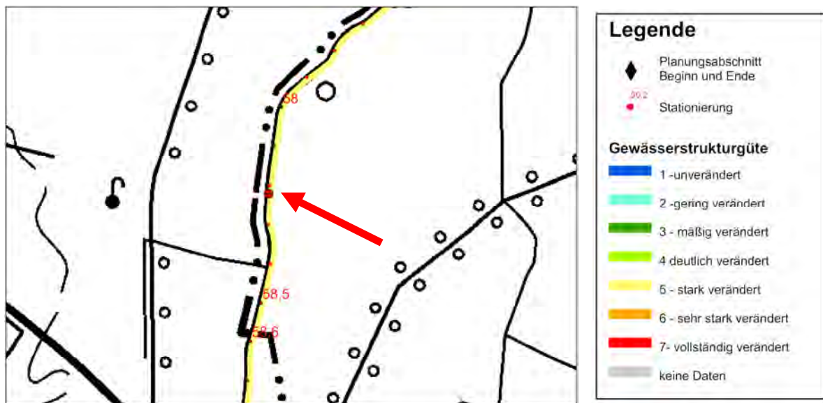
Abbildung 3: Ergebnis der Gewässerstrukturkartierung
